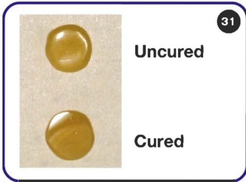
รูปที่ 31 แสดงความแตกต่างของสีเรซินคอมโพสิตที่ไม่บ่มตัว (บน) และที่บ่มตัวแล้ว (ล่าง)
